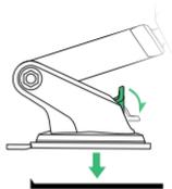
Premere la leva di bloccaggio verso il basso per attivare l'aspirazione.
