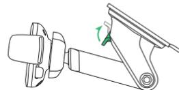
Enclenchez le levier de verrouillage vers le bas pour mettre en œuvre la succion.
