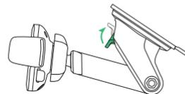
Premere la leva di bloccaggio verso il basso per attivare l'aspirazione.
