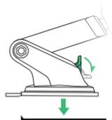
Drücken Sie den Verriegelungshebel nach unten, um die Absaugung zu aktivieren.
