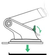
Presione hacia abajo la palanca de bloqueo para activar la succión.
