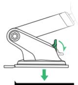
Enclenchez le levier de verrouillage vers le bas pour mettre en œuvre la succion.
