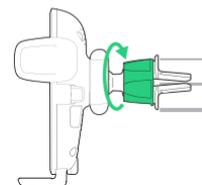
2. Desserrer le verrou tournant et poussez le support complètement sur la grille d'aération.
