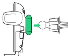
1. Presione el soporte de ventilación y la horquilla y apriete la perilla de la horquilla.
