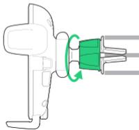
3. Ziehen Sie die Drehverriegelung langsam an, um eine sichere Verbindung mit dem Lüftungsschlitz zu gewährleisten.
