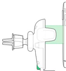
4. Allineare la parte posteriore dello smartphone direttamente al centro del pulsante di attivazione Easy One Touch del supporto. La spia si accende quando si trova la connessione di ricarica.
