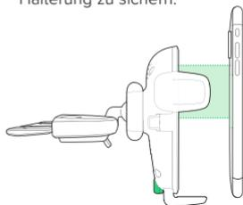
4. Richten Sie die Rückseite des Smartphones direkt auf der Easy One Touch-Auslösetaste des Mount aus. Die Kontrollleuchte leuchtet auf, wenn die Ladeverbindung gefunden wird.
