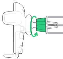
3. Serrez lentement le verrou tournant pour obtenir une connexion sécurisée à la grille d'aération.
