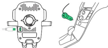
! L'Easy One Touch Wireless 2 est alimenté via un câble micro-USB. L'Easy One Touch Wireless 2 n'a pas d'interrupteur marche/arrêt. Une fois que l'appareil est branché à la source d'alimentation, il reste allumé.
