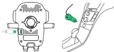
! Il Easy One Touch Wireless 2 non ha un interruttore on/off. Una volta collegato il dispositivo alla fonte di alimentazione, rimarrà acceso.
