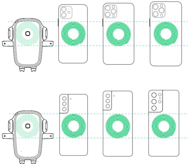
! Stellen Sie für ein optimales drahtloses Laden sicher, dass die Qi-Spulen Ihres Smartphones und der Halterung ausgerichtet sind.
