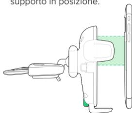
4. Allineare la parte posteriore dello smartphone direttamente al centro del pulsante di attivazione Easy One Touch del supporto. La spia si accende quando si trova la connessione di ricarica.
