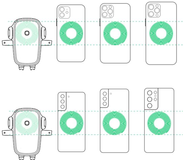
! Per una ricarica wireless ottimale, assicurarsi che lo smartphone e le bobine Qi montate siano allineate.
