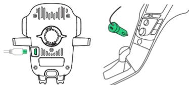
! El Easy One Touch Wireless 2 no tiene un interruptor de encendido/apagado, y se alimenta via cable micro-USB. Una vez que el dispositivo esté conectado a la fuente de alimentación, permanecerá encendido.
