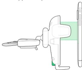
4. Alignez directement l'arrière du smartphone sur le centre du bouton de déclenchement de l'Easy One Touch. Le voyant s'allumera lorsque la connexion de charge aura été trouvée.
