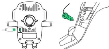
! Das Easy One Touch Wireless 2 wird über ein Micro-USB-Kabel mit Strom versorgt. Easy One Touch Wireless verfügt nicht über einen Ein-/Ausschalter. Sobald das Gerät an die Stromquelle angeschlossen ist, bleibt es eingeschaltet.
