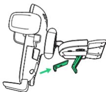
3. Compruebe que la montura esté firme y, de ser necesario, inserte el soporte.
