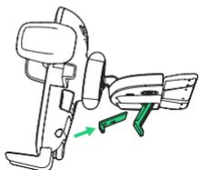
3. Testen Sie, ob die Halterung sicher ist, und setzen Sie nötigenfalls eine Sicherheitsklammer ein.
