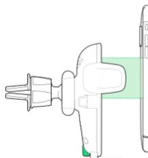
4. Alinee la parte posterior del teléfono inteligente directamente en el centro del botón de activación del Easy One Touch. La luz de indicación se encenderá cuando se encuentre la conexión de carga.
