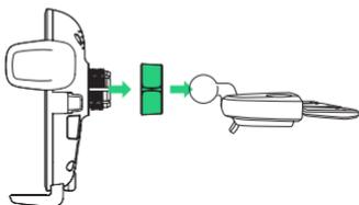
1. Premere insieme il supporto dello slot per CD e la base e serrare la manopola della base.
