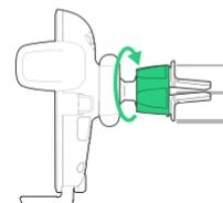
2. Allentare il twist lock e spingere completamente il supporto delle palette della bocchetta.
