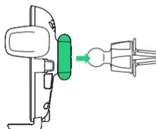
1. Pressez simultanément sur le support et l'évent, resserrez la vis du support.
