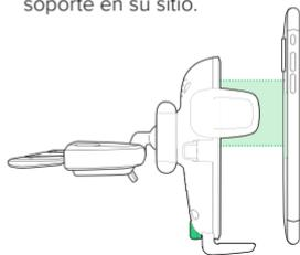
4. Alinee la parte posterior del teléfono inteligente directamente en el centro del botón de activación del Easy One Touch. La luz de indicación se encenderá cuando se encuentre la conexión de carga.
