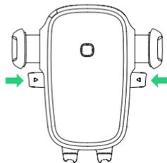
2. Appuyez votre appareil contre le bouton d'enclenchement Easy One Touch. Les bras de montage se fermeront automatiquement au contact et maintiendront l'appareil au cours de la conduite.
