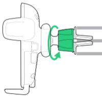
3. Apriete lentamente el cierre de giro para una conexión segura a la salida de aire.
