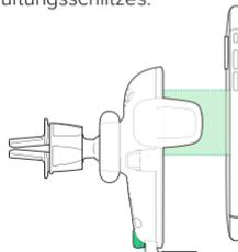
4. Richten Sie die Rückseite des Smartphones direkt auf der Easy One Touch-Auslösetaste des Mount aus. Die Kontrollleuchte leuchtet auf, wenn die Ladeverbindung gefunden wird.
