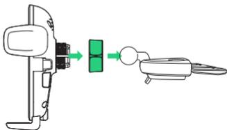
1. Bringen Sie die CD-Halterung an die Waage. Mit dem Einstellknopf festziehen.
