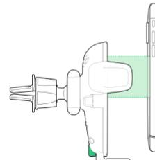
4. Alignez directement l'arrière du smartphone sur le centre du bouton de déclenchement de l'Easy One Touch. Le voyant s'allumera lorsque la connexion de charge aura été trouvée.
