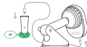
\*Der Velox-Armaturenbrettbefestigung hat keinen Ein/Aus-Schalter. Sobald das Kabel eingesteckt ist und das Fahrzeug eingeschaltet wird, ist die Halterung eingeschaltet.
