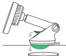
Il cuscinetto del cruscotto è montato con adesivo semi-permanente. Una volta rimosso, non si può rimontare.
