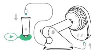
\*Le support de tableau de bord Velox n'a pas l'interrupteur marche/arrêt. Une fois le câble branché et le véhicule allumé, le support restera allumé.
