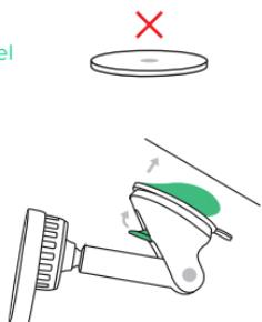
2. Presione la palanca de bloqueo para activar la succión.
