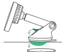
3. Enclenchez le levier de verrouillage vers le bas pour mettre en œuvre la succion.
