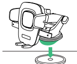
2. 吸着カップのプラスチックカバーを外し、ダッシュボードパッドにマウントをしっかりと付ける。
